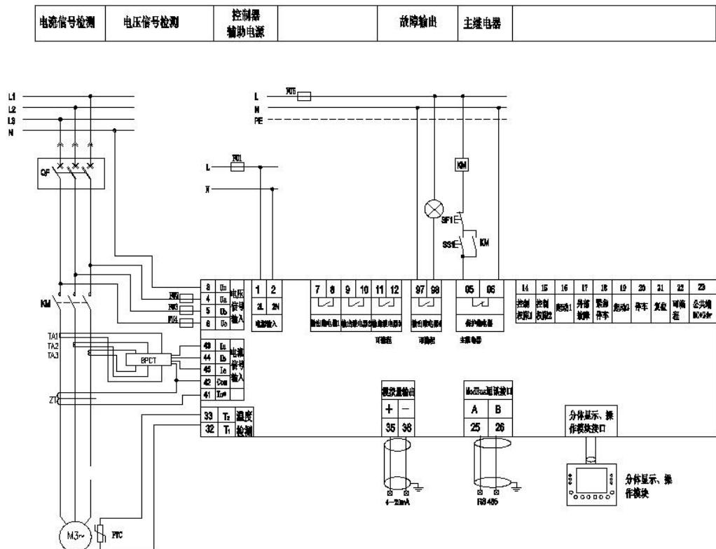
注：选用 1A、5A 规格的 DVG3 保护器时，需要先通过/1、/5 的互感器将一次侧电流转换成 1A、5A 的电流，然后再通过标配的 100A/20mA 电流互感器输入到保护器使用。图中 TA1、TA2、TA3 为/1、
