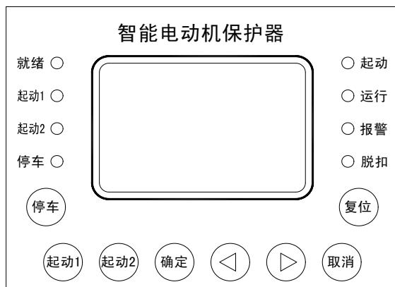
图 13 DVG3 90L 显示模块面板
