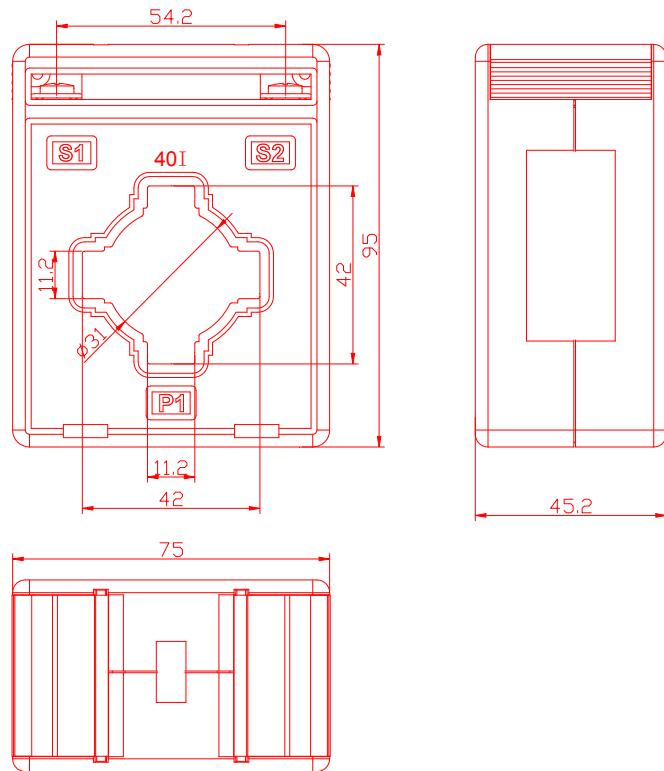
图 8 250A 外置电流互感器外形尺寸
