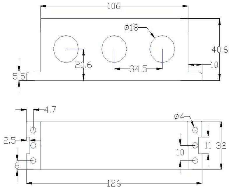
图 7 100A 及以下的电流互感器外形尺寸
