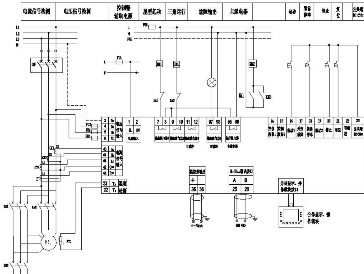
9.5 DVG3 智能型电动机保护器自耦降压起动模式接线图（适用于 1.6、6.3、25、100、250、800A 电流规格，电流互感器标配）
