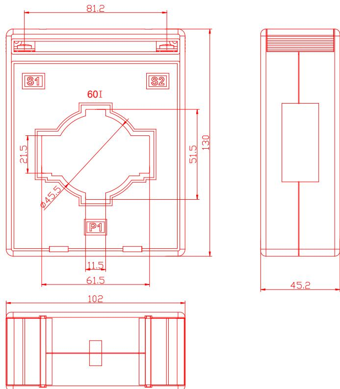
图 9 800A 外置电流互感器外形尺寸
