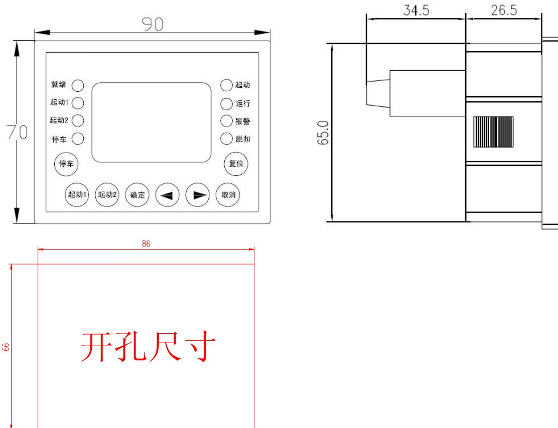
图 12 90L 显示模块外形尺寸
