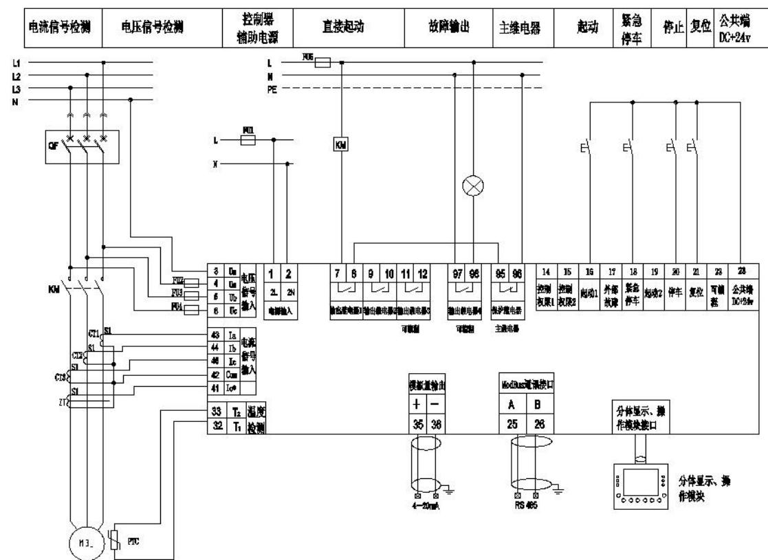
9.3 DVG3 智能型电动机保护器双向起动模式接线图（适用于 1.6、6.3、25、100、250、800A 电流规格，电流互感器标配）
